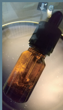
レンズ枠の角度を調整 すると埃が浮き上がります
